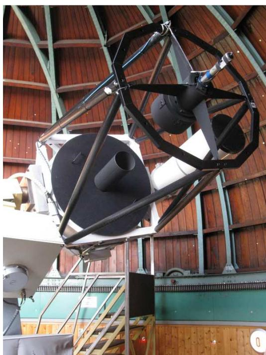
Abb. 3: Das Hauptinstrument der Sternwarte: ein 60 cm Cassegrain mit 17,5 cm Refraktor als Leitrohr (Foto: W. Steinicke)
